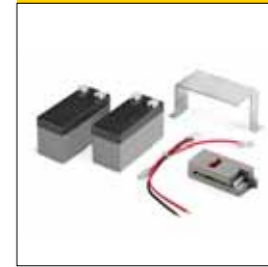
Zestaw do centrali BRAINY24 wyposażony w kartę ładowania CBY.24V, akumulatory 1.2 Ah i podstawkę. Karta CBY.24V umożliwia ładowanie dwóch różnych typów akumulatorów: niklowo-metalowo-wodorowego i ołowiowego
