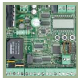
Centrala BRAINY24 24 Vdc z wbudowanym odbiornikiem i wielozakresowym sterowaniem logicznym, które jest programowane za pomocą wyświetlacza
