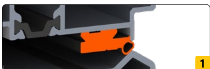
DODATKOWA USZCZELKA EPDM USZCZELNIA POŁĄCZENIE SKRZYDŁA Z PROGIEM
