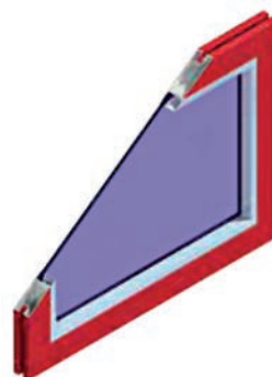
Profil z panelem przeszklonym.
