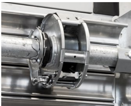
ZABEZPIECZENIE w przypadku pęknięcia sprężyn
